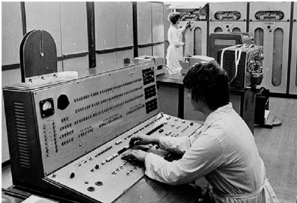
Ảnh 1. Máy tính Minsk-22: bàn điều khiển trung tâm, phần chính của máy là các tủ đứng ở bên trái, các tủ bên phải là bộ nhớ ngoài gồm các tủ chứa băng từ, trước các tủ băng từ là máy đọc dữ liệu từ băng giấy. Máy Minsk-22 ở 39 Trần Hưng Đạo 1969 bố trí đúng theo trật tự trong ảnh.
